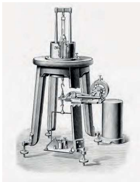
Rys. 3. Aparat piezoelektryczny wg metody Curie (Zum Art. Radioactivitet, Leipzig.). Rysunek ze zbiorów Izabeli Nowak
