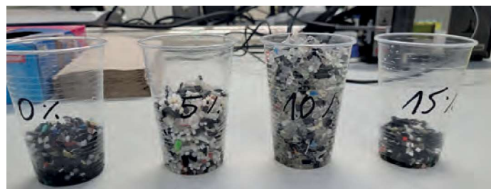
Rysunek 7. Próbkę rozdzielone po badaniu flotacji w zależności od stężenia roztworu
