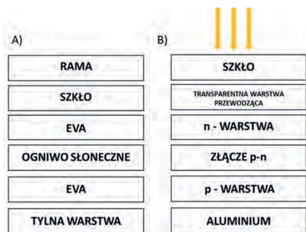
Rys. 7. a) Panel słoneczny (EVA – ang. ethylene vinyl acetate ); b) krystaliczne ogniwo krzemowe (c-Si)
