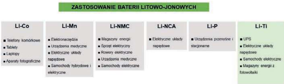
Rys. 5. Zastosowanie ogniw litowo-jonowych w zależności od zastosowanych materiałów elektrodowych [8]
